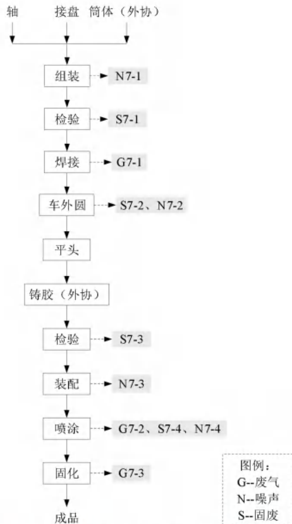
图 2-7 滚筒生产工艺流程图及排污节点图
