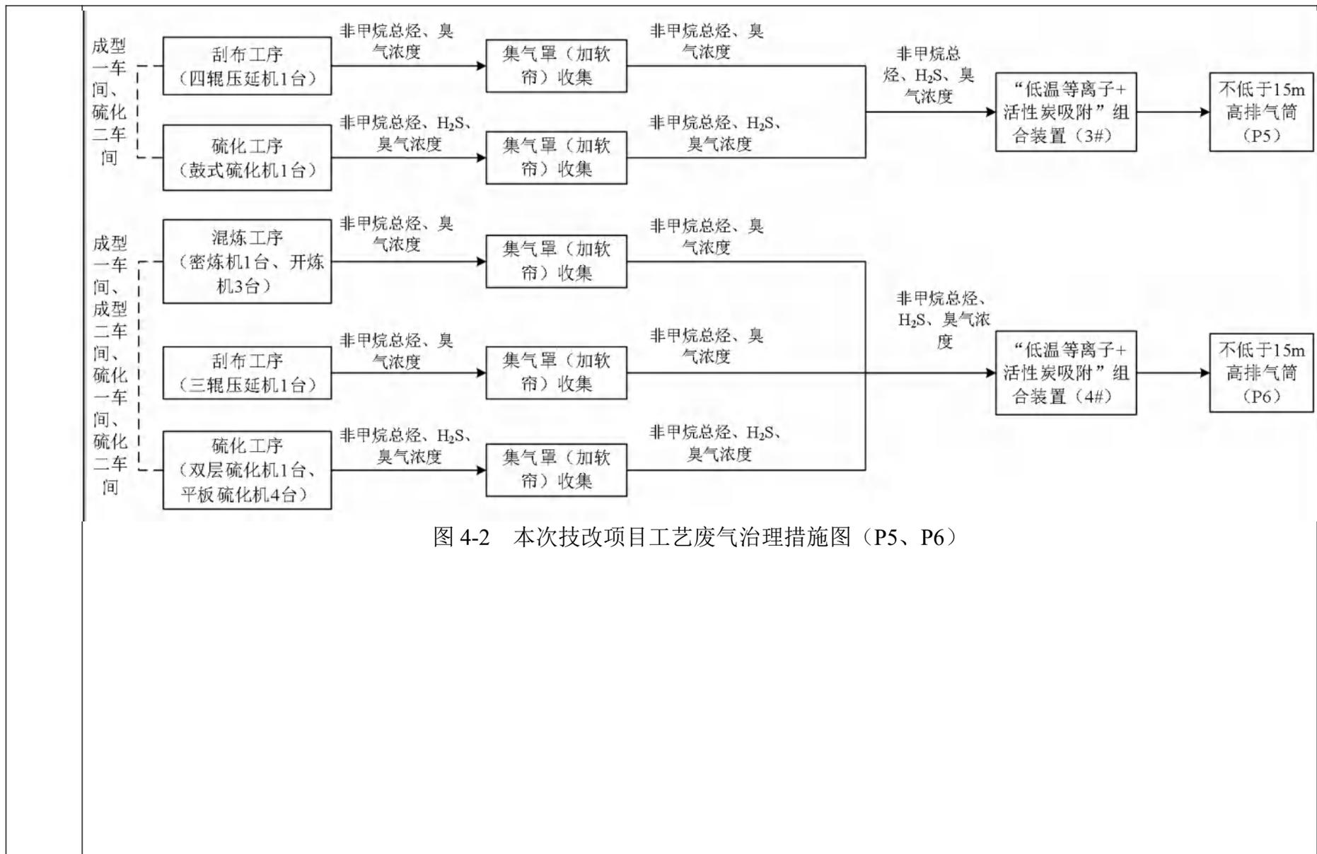
图 4-2 本次技改项目工艺废气治理措施图 (P5、P6)
